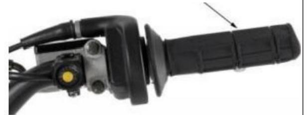
1. ( ) Verifique que el **conjunto del acelerador** esté correctamente colocado y que los **pernos de sujeción** estén apretados.
